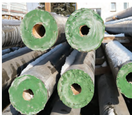
Obr. 32, 33 a 34. Betonové sloupky představují pro sýčka obecného významnou technickou past. Jejich vnitřní dutina o průměru 70–100 mm v horní části se směrem dolů rozšiřuje, její stěny jsou hladké, pták se nedokáže dostat ven a hyne hladem. © V. Škorpíková, K. Poprach Fig. 32, 33 and 34. Concrete poles are very danger for Little Owls. Their inner holes (diameter 70–100 mm) are wider in a low part of the pole, its walls are smooth, so birds could be trapped inside, where they die of starvation. © V. Škorpíková, K. Poprach
